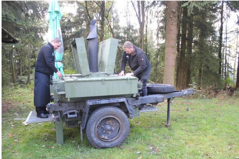
hat einen doppelwandigen Kessel für 150 Liter Inhalt, einen einwandigen Kessel mit 75 Liter und eine Bratpfanne (Edelstahl 30Liter). Alles mit Hartholz zu befeuern
